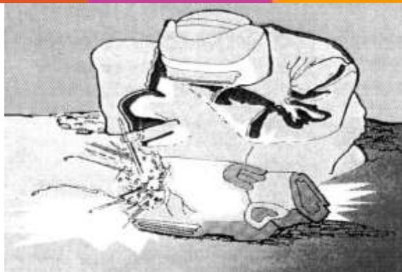
**Fig. 6** - Antes de soldar sobre piezas huecas de fundición asegurarse de que están bien aireadas y no contienen combustible en su interior.
